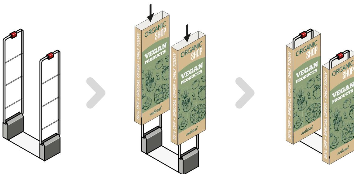
Insérez la pièce finie dans la partie supérieure de l'alarme et ... c'est tout!
